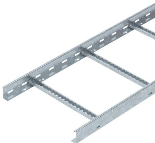
Bandeja de escalera con altura de ala de 60 mm con peldaños de perfil C30 soldados, abiertos hacia arriba. Barra lateral enrollada como refuerzo y como protección de bordes. La fijación en la escuadra se realiza con bridas de fijación LKS 40. La medida de la ranura del peldaño es de 16,5 mm; la abrazadera de media caña sobre perfil adecuada es 2056. Aislamiento magnético sin tapa 10 dB, con tapa 15 dB.
