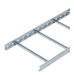
Bandeja de escalera con altura de ala de 60 mm con peldaños de perfil C30 soldados, abiertos hacia arriba. Barra lateral enrollada como refuerzo y como protección de bordes. La fijación en la escuadra se realiza con bridas de fijación LKS 40. La medida de la ranura del peldaño es de 16,5 mm; la abrazadera de media caña sobre perfil adecuada es 2056.
