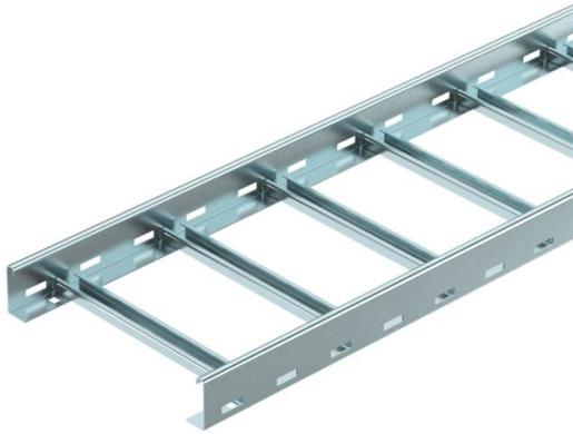
Bandeja de escalera para el tendido horizontal de cables y líneas. Se puede utilizar como estructura de soporte estándar para el mantenimiento de función según DIN 4102 parte 12. Clases de mantenimiento de función de E30 a E90. Con remache de perfil en C remachado abierto en la parte superior.
