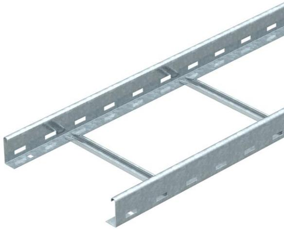
Bandeja de escalera con barra lateral perforada de ala 60 mm con peldaños de perfil en C abiertos hacia arriba (modelo NS), remachados.
