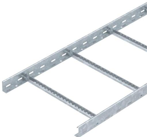
Bandeja de escalera con barra lateral perforada de ala 60 mm con peldaños de perfil en C abiertos hacia arriba (modelo VS), remachados.
