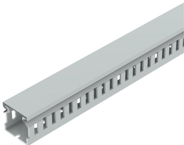
Canal de cableado libre de halógenos incl. parte superior y perforación en la base para el tendido horizontal y vertical de cables eléctricos y líneas en el cuadro eléctrico. Con cinta adhesiva de doble cara en la base del canal como ayuda de montaje. Versión como canal métrico. Los puentes pueden romperse sin necesidad de herramientas. Longitudes especiales disponibles previa solicitud. Probado según DIN EN 50085-2-3. Base y tapa en el juego.
