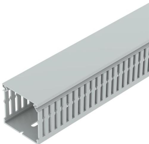
Canal de cableado libre de halógenos incl. parte superior y perforación en la base para el tendido horizontal y vertical de cables eléctricos y líneas en el cuadro eléctrico. Con cinta adhesiva de doble cara en la base del canal como ayuda de montaje. Versión como canal métrico. Los puentes pueden romperse sin necesidad de herramientas. Longitudes especiales disponibles previa solicitud. Probado según DIN EN 50085-2-3. Base y tapa en el juego.
