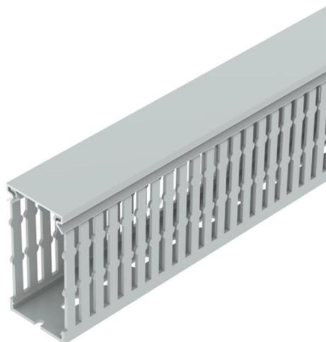
Canal de cableado libre de halógenos incl. parte superior y perforación en la base para el tendido horizontal y vertical de cables eléctricos y líneas en el cuadro eléctrico. Con cinta adhesiva de doble cara en la base del canal como ayuda de montaje. Versión como canal métrico. Los puentes pueden romperse sin necesidad de herramientas. Longitudes especiales disponibles previa solicitud. Probado según DIN EN 50085-2-3. Base y tapa en el juego.
