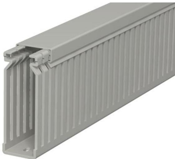
Canal de cableado incl. parte superior y perforación en la base para el tendido horizontal y vertical de cables eléctricos y líneas en el cuadro eléctrico. Versión como canal métrico. La dimensión nominal del tamaño del sistema corresponde a la dimensión interior de los canales. Los puentes pueden romperse sin necesidad de herramientas. Los puntos de rotura predefinidos permiten la instalación a ras de suelo. Probado según DIN EN 50085-2-3. Longitudes especiales disponibles previa solicitud.
