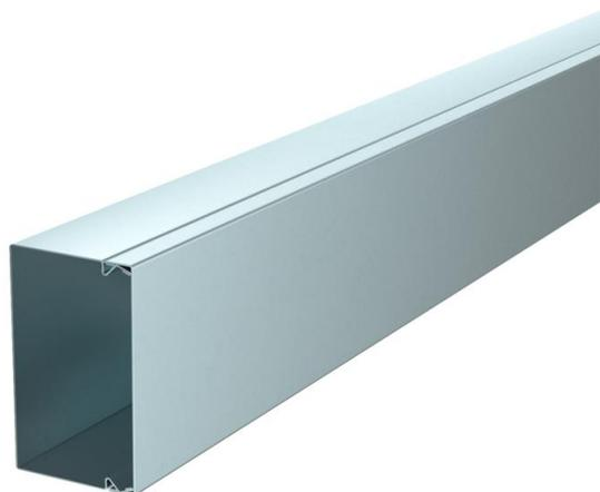
Tapa de canal y base con orificios. La conexión equipotencial entre la base y la tapa del canal está garantizada sin necesidad de ningún elemento adicional. El canal tipo LKM 60100 está testado como sistema de instalación para mantenimiento de función según DIN 4102, parte 12. ¡Tenga en cuenta los tipos de cable probados en el área BSS de sistemas de protección contra incendios!
