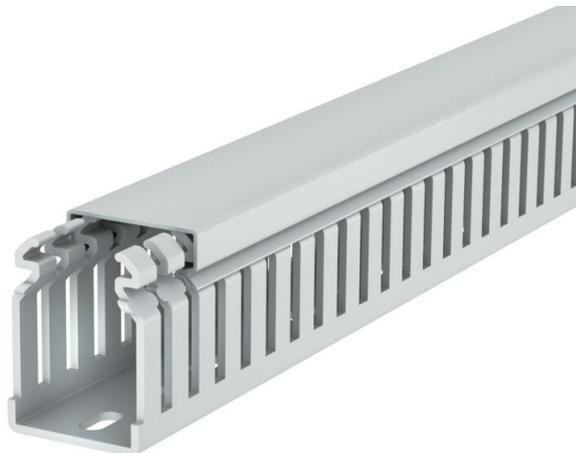
Canal de cableado libre de halógenos según DIN EN 50085-2-3 incl. parte superior y perforación en la base para el tendido horizontal y vertical de cables eléctricos y líneas en el cuadro eléctrico. Versión como canal DIN. Los puentes pueden romperse sin necesidad de herramientas. Los puntos de rotura predefinidos permiten la instalación a ras de suelo. Probado según DIN EN 50085-2-3. Longitudes especiales disponibles previa solicitud.
