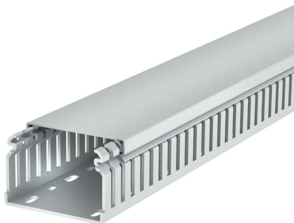
Canal de cableado libre de halógenos según DIN EN 50085-2-3 incl. parte superior y perforación en la base para el tendido horizontal y vertical de cables eléctricos y líneas en el cuadro eléctrico. Versión como canal DIN. Los puentes pueden romperse sin necesidad de herramientas. Los puntos de rotura predefinidos permiten la instalación a ras de suelo. Probado según DIN EN 50085-2-3. Longitudes especiales disponibles previa solicitud.
