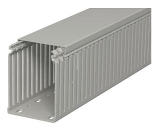
Canal de cableado según DIN EN 50085-2-3 incl. parte superior y perforación en la base para el tendido horizontal y vertical de cables eléctricos y líneas en el cuadro eléctrico. Versión como canal DIN. Los puentes pueden romperse sin necesidad de herramientas. Los puntos de rotura predefinidos permiten la instalación a ras de suelo. Probado según DIN EN 50085-2-3. Longitudes especiales disponibles previa solicitud.
