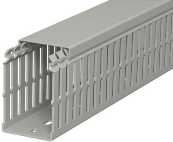
Canal de cableado según DIN EN 50085-2-3 incl. parte superior y perforación en la base para el tendido horizontal y vertical de cables eléctricos y líneas en el cuadro eléctrico. Versión como canal DIN. Los puentes pueden romperse sin necesidad de herramientas. Los puntos de rotura predefinidos permiten la instalación a ras de suelo. Los estrechamientos en las ranuras laterales impiden la caída de los cables. Probado según DIN EN 50085-2-3. Longitudes especiales disponibles previa solicitud.
