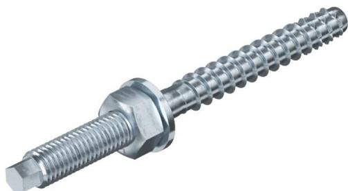
Anclaje para el montaje directo sin tacos de hormigón fisurado y no fisurado, y muros. Con rosca de conexión y arandela para soportar grandes cargas. Apropiado para la fijación de perfiles colgantes y escuadras de pared en montaje pasante.
