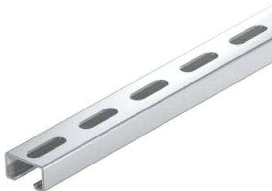
Perfiles C para cargas pesadas para la instalación individual de construcciones portantes para, p. ej., bandejas portacables o como consola para armarios eléctricos. También utilizable para el cableado, en combinación con abrazaderas sobre perfil con patillas tipo U.
