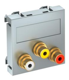
Soporte multimedia con tres conectores cinch para audio-vídeo, salida recta de cable, con campo identificativo, tres conectores cinch (RCA) en versión toma-toma, código cromático amarillo/rojo/blanco. Placa de soporte con enganche, adecuada para el montaje vertical y horizontal en el entorno del sistema.
