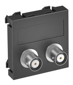
Soporte multimedia con dos conectores BNC para audio-vídeo, salida recta de cable, con campo identificativo, dos uniones BNC en versión toma-toma. Placa de soporte con enganche, apropiada para el montaje vertical y horizontal en el entorno del sistema.
