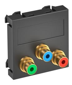
Soporte multimedia con tres conectores cinch para vídeo, salida recta de cable, con campo identificativo, tres conectores cinch (RCA) en versión toma-toma, código cromático rojo/verde/azul. Placa de soporte con enganche, adecuada para el montaje vertical y horizontal en el entorno del sistema.
