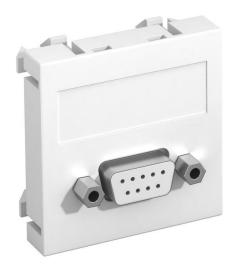
Soporte multimedia con un conector D-Sub9, salida recta de cable, con campo identificativo, conector D-Sub9 (RS232) con conexión por tornillo. Placa de soporte con enganche, adecuada para el montaje vertical y horizontal en el entorno del sistema.
