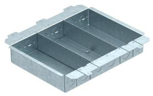
Soportes de montaje cerrados para alojamiento de 3 tapas APMT2. Los soportes de montaje se fijan bajo la unidad portamecanismos GES9DB. Cada uno con 6 aberturas perforadas M20 y M25 para el montaje de mangueras de instalación flexibles.
