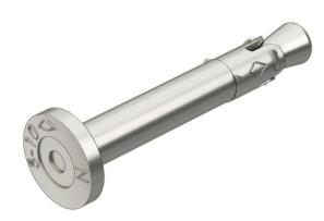
El anclaje de clavo N se utiliza en fijaciones múltiples de sistemas autoportantes en zonas con influencias corrosivas en hormigón con grietas y sin grietas, y combina las ventajas de un anclaje de perno con un montaje más sencillo. El anclaje de clavo solo necesita introducirse en el agujero perforado. Cuando aparece la carga, al anclaje de clavo se expande y se ancla en el agujero perforado.
