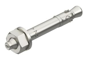
El anclaje con clavos N se puede utilizar en fijaciones múltiples de sistemas no portantes en exteriores e interiores en hormigón fisurado o no fisurado, y ofrece las ventajas de un anclaje con pernos con un montaje aún más sencillo. El anclaje con clavos solo necesita introducirse en el agujero. No se necesita la aplicación posterior de un par de giro. Al actuar la carga los clavos se expanden
