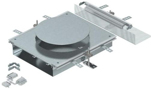
Ampliación de canal lista, para montar una unidad portamecanismos de tamaño R9. Está compuesta por una base de canal (con perfiles laterales y de apoyo en el pavimento), una tapa de canal con abertura de montaje cerrada de forma ciega y un final de canal. Se suministra con 3 ángulos de fijación de altura regulable, 3 piezas de anclaje y una pieza angular. Tamaño de la abertura de montaje apropiado para montar una unidad de montaje redonda de tamaño nominal R9 o R9/55.
