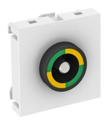
Caja equipotencial según DIN 42801, toma en negro anillo de color verde-amarillo, conexión de cable trasera con bornes de rosca M6, incl. dos tuercas, arandelas y un arandela dentada.
