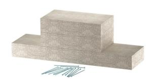
Cuello de corriente para pared para canal de protección contra el fuego PYROLINE® Con D El90, tipo PLCD D091220 compuesto por hormigón ligero con fibra de vidrio, resistente al agua y a las heladas para el montaje en el canal de protección contra el fuego en el área de las conexiones de pared y techo o los tendidos de pared y techo. Compuesto de 3 placas individuales (anchura 100 mm, grosor 40 mm). Incluidos tornillos de cabeza avellanada. Incluidos tornillos de cabeza avellanada.
