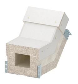
Curva vertical ascendente para canal de protección contra el fuego PYROLINE® Con S El90, tipo PLCS D090810 compuesto por hormigón ligero con fibra de vidrio, resistente al agua y a las heladas para la realización de cambios de sentido verticales (45°) a lo largo del canal. Los conectores montados aseguran un montaje rápido in situ, mientras que las cubiertas colocadas sin apretar garantizan una inspección y reasignación rápidas. Incluidos tornillos de unión y cintas selladoras.
