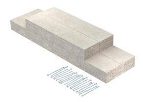
Cuello de corriente para pared para canal de protección contra el fuego PYROLINE® Con S El90, tipo PLCS D091220 compuesto por hormigón ligero con fibra de vidrio, resistente al agua y a las heladas para el montaje en el canal de protección contra el fuego en el área de las conexiones de pared y los tendidos de pared. Compuesto de 4 placas individuales (anchura 50 mm, grosor 30 mm). Incluidos tornillos de cabeza avellanada.
