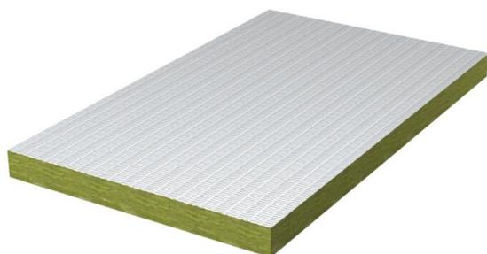
Con pintura intumescente PYROCOAT® ASX, placa de fibra de mineral con revestimiento previo como base para el sistema de aislamiento blando PYROPLATE® Fibre. Placa de 50 mm para aislamiento conforme a la homologación alemana. Uso en interiores.
