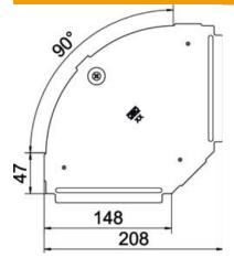
Ancho 150 mm Espesor de chapa 0,75 mm
