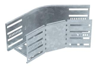
Curva de 45° para establecer una derivación horizontal, accesorio para bandejas portacables encajables y atornillables con ala de 110 mm. Montaje sin tornillos con abrazaderas dobles o unión atornillada con tornillos redondos planos FRS y tuercas combinadas M6. De uso en interiores y exteriores. El material de fijación se debe pedir por separado.
