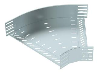
Curva de 45° para establecer una derivación horizontal, accesorio para bandejas portacables encajables y atornillables con ala de 110 mm. Montaje sin tornillos con abrazaderas dobles o unión atornillada con tornillos redondos planos FRS y tuercas combinadas M6. De uso en espacio interior. El material de fijación se debe pedir por separado.
