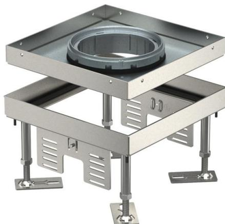
Conjunto de tapa y marco cuadrado para cargas pesadas, versión para tubo. Sirve para crear una abertura de revisión de tamaño nominal 4 en acabados de pavimento que precisen de una limpieza en seco o con agua. Se pueden usar tanto para sistemas de canalización empotrados, como para suelos técnicos o huecos. Clase de carga 1 a 10 kN.
