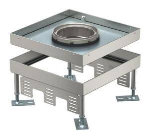
Conjunto de tapa y marco cuadrado de altura regulable y alta resistencia para tubos de tamaño nominal 9 para montar dispositivos de instalación en sistemas de canalización, suelos dobles y huecos en suelos limpiados en seco o en húmedo en interiores. Clase de carga 1 a 10 kN.
