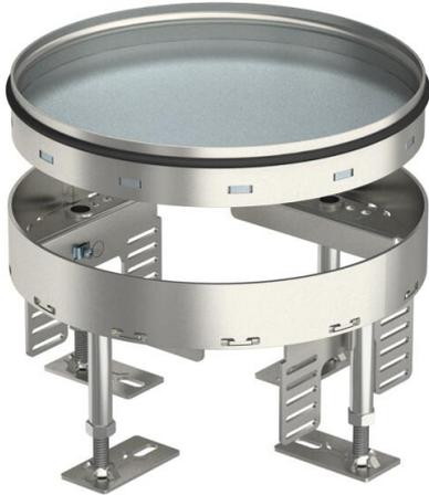
Tapa ciega y marco con altura regulable de tamaño R4 para practicar una abertura de revisión en pavimentos que precisan una limpieza en seco o con agua. Sólo son apropiados para pavimentos pulidos.
