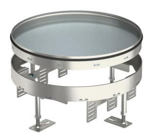
Tapa y marco redondos para cargas pesadas, versión ciega, de tamaño R9, para practicar una abertura de revisión en sistemas de canalización y en suelos técnicos y huecos, para pavimentos que precisan una limpieza en seco o con agua. Clase de carga 2 hasta 20 kN. Sólo son apropiados para pavimentos pulidos.
