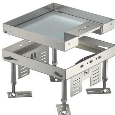
Tapa y marco de altura regulable con salida para cables, 2 compartimentos. Pueden instalarse 2 tapas ciegas APMT2. Para la instalación de 2 soportes universales UT3 para 4 mecanismos individuales con anillo/estribo de soporte o 6 aparatos Modul 45.
