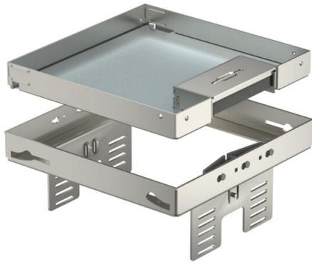
Conjunto de tapa y marco de altura regulable y desacoplada del suelo de tamaño nominal 4, con salida de cable, para el montaje de mecanismos en pavimentos que precisan limpieza en seco, para montar en cajas bajo suelo UZD250-3 o UZD350-3, en combinación con una tapa de montaje DUG../4 o en UGD250-3/4 o UGD350-3/4. El montaje se efectúa mediante un ángulo de nivelación (pedir por separado) en el perfil del marco de aluminio de las cajas bajo suelo.
