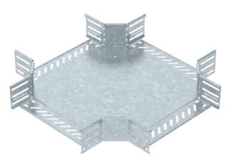
Cruce para establecer una derivación horizontal, accesorio para bandejas portacables encajables y atornillables con ala de 85 mm. Montaje sin tornillos con abrazaderas dobles o unión atornillada con tornillos redondos planos FRS y tuercas combinadas M6. De uso en interiores y exteriores. El material de fijación se debe pedir por separado.
