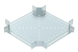
Cruce para establecer una derivación horizontal, accesorio para bandejas portacables encajables y atornillables con ala de 85 mm. Montaje sin tornillos con abrazaderas dobles o unión atornillada con tornillos redondos planos FRS y tuercas combinadas M6. De uso en espacio interior. El material de fijación se debe pedir por separado.
