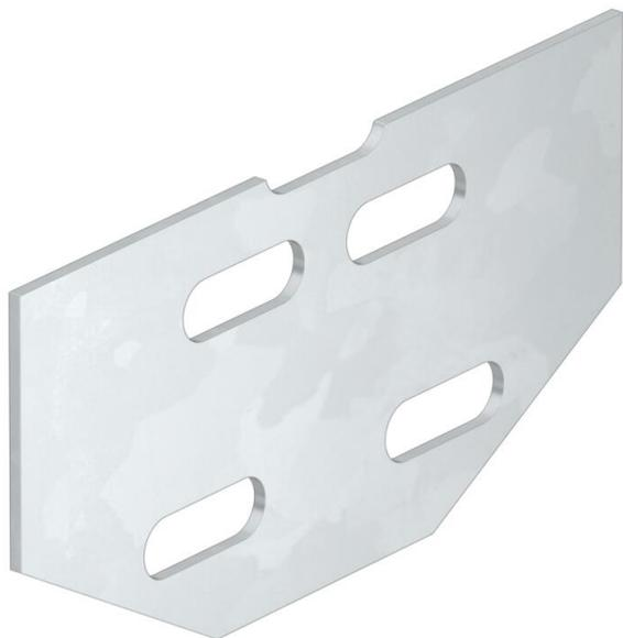
La unión recta puede utilizarse para la unión de bandejas portacables con ala de 60 mm. Las uniones biseladas ascendente o descendente hasta un ángulo de 60° también se pueden realizar con esta unión.
