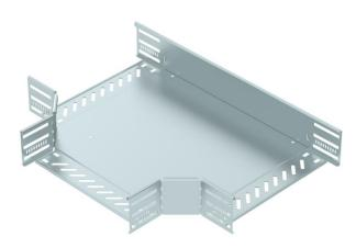
Pieza en T para establecer una derivación horizontal, accesorio para bandejas portacables encajables y atornillables con ala de 85 mm. Montaje sin tornillos con abrazaderas dobles o unión atornillada con tornillos redondos planos FRS y tuercas combinadas M6. De uso en espacio interior. El material de fijación se debe pedir por separado.
