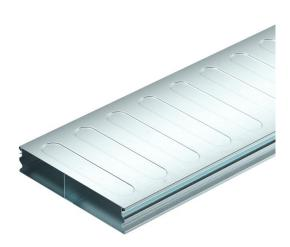
Canal para suelo (2 piezas) para el tendido de cables y líneas en sistemas bajo suelo con revestimiento de solado según la norma EN 50085-2-2. Tapa del canal desmontable y de encaje continuo. Con tabique separador en la parte inferior del canal
