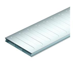
Canal para suelo (2 piezas) para el tendido de cables y líneas en sistemas bajo suelo con revestimiento de solado según la norma EN 50085-2-2. Tapa del canal desmontable y de encaje continuo. Con tabique separador en la parte inferior del canal
