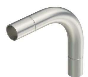
Curva de  $90^\circ$  con manguitos moldeados para tubos de instalación eléctrica según EN 61386-1. Con pared interior sin rebabas.
