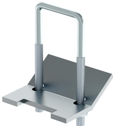
Elemento de conexión para la fijación por ambos lados de perfiles en vigas metálicas. La fijación es posible independientemente de la disposición del orificio de perfil. La longitud de perfil debe ser como mínimo la anchura de la viga metálica + 2 x 50mm.
