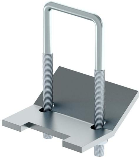
Elemento de conexión para la fijación por ambos lados de perfiles en vigas metálicas. La fijación es posible independientemente de la disposición del orificio de perfil. La longitud de carril debería ser como mínimo el ancho del soporte de acero + 2 x 50 mm.
