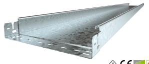
Bandeja portacables sin perforar con sistema de fijación rápida integrado. La longitud útil de la bandeja portacables es 3.000 mm. La conexión equipotencial continua queda asegurada sin componentes adiciona-
