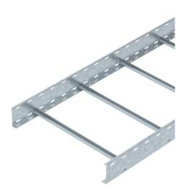
Bandeja de escalera de ala 110 mm con peldaños de perfil en C30 soldados, abiertos hacia arriba. Barra lateral enrollada como refuerzo y como protección de bordes. La fijación en la escuadra se realiza con bridas de fijación LKS 40. La medida de la ranura del peldaño es de 16,5 mm; la abrazadera de media caña sobre perfil adecuada es 2056.
