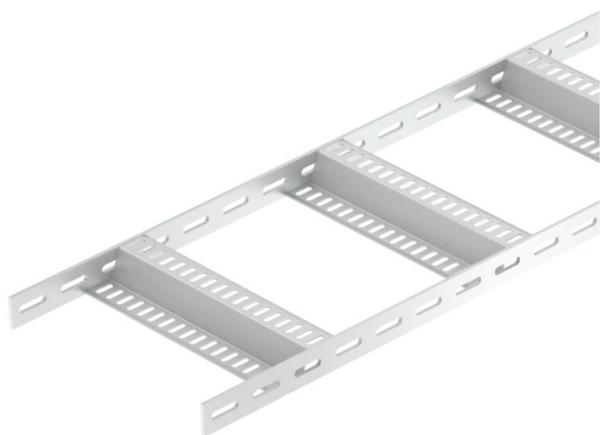
Bandeja de escalera para barcos con barra lateral perforada con altura de ala de 40 mm con peldaños en Z, soldados, perforados. La bandeja de escalera para barcos incluidas piezas preformadas está disponible en acero inoxidable previa solicitud. Posible recubrimiento en polvo según colores RAL.
